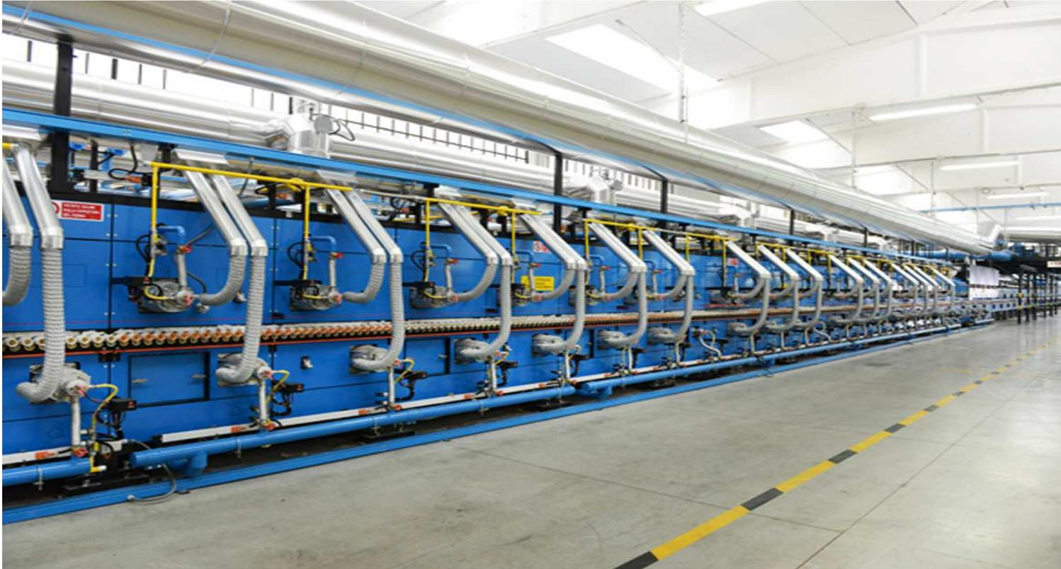
**Il nuovo forno EKO utilizza il nuovo concetto dei flussi trasversali in zona cottura, e il tradizionale funzionamento a flussi longitudinali in preriscaldamento.**
