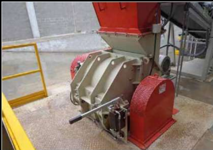
Mulino con sistema idraulico di apertura e manutenzione rapida Mill with hydraulic opening system and quick maintenance
